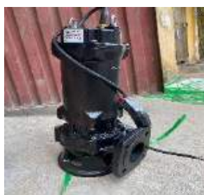
Hình 3.9. Bơm chìm bể lắng
