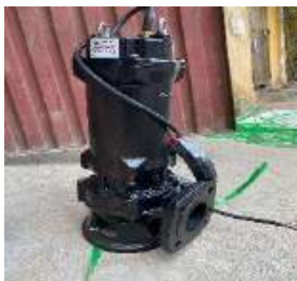
Hình 3.4. Bơm chìm nước thải
