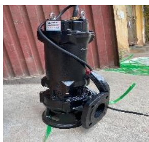
Hình 3.9. Bơm chìm bể lắng
