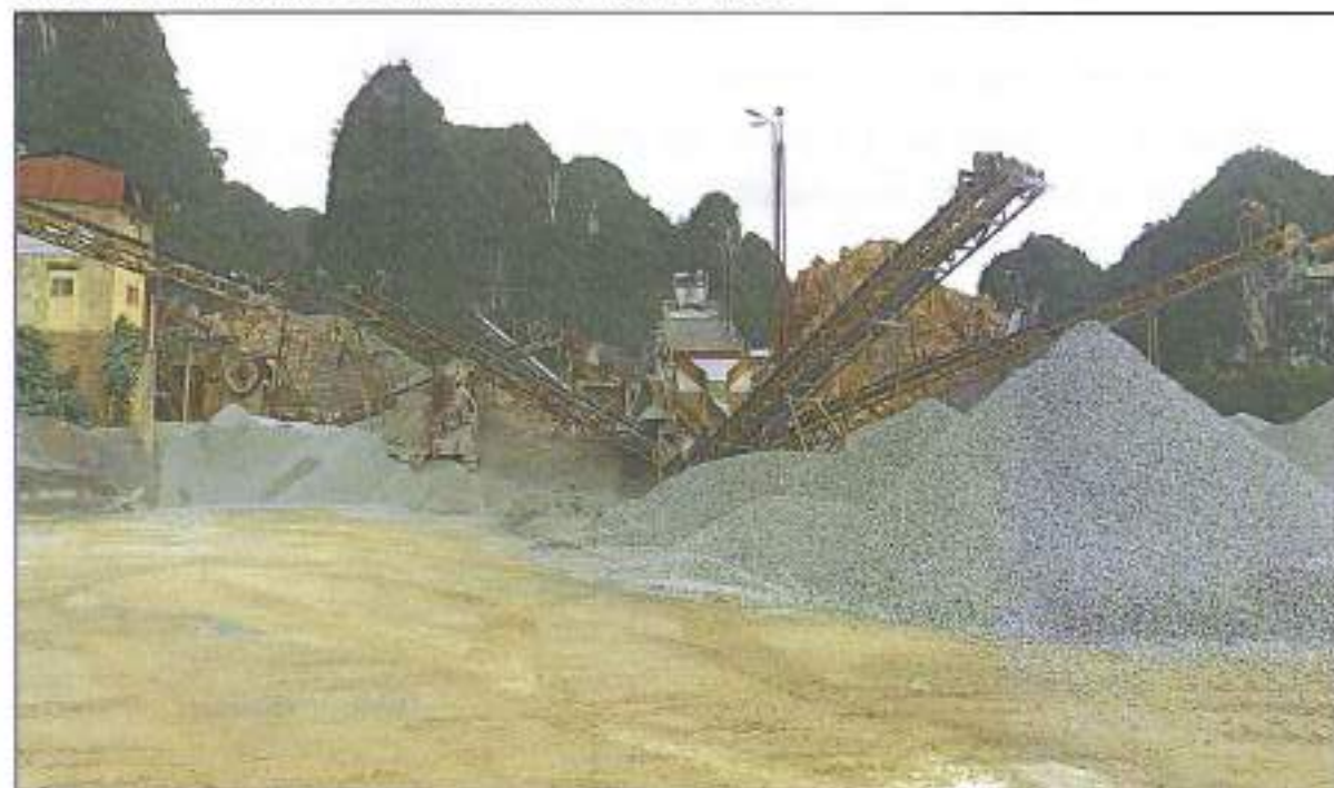
Hình 1.3. Hiện trạng dây chuyền chế biến đá của mỏ
